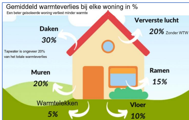
Figuur 5. Warmteverlies van een doorsneewoning in percentages. Bij een goed geïsoleerd gebouw zijn de percentages ongeveer hetzelfde, maar met een WTW op de ventilatielucht wordt dat ventilatiepercentage kleiner dan 5%.
