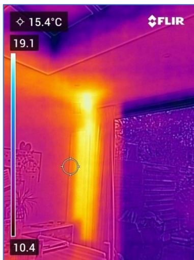
Figuren 29. Verticale design radiator. Infra-Rood foto en de gewone foto.
