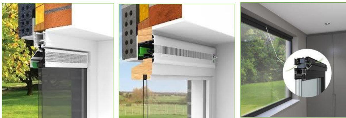
Figuren 30. Links : Ventilatioerooster boven op het isolatieglas in het kozijn en van buiten zichtbaar. Al deze types moeten precies op de glasmaat besteld worden. Zelf regulerend raam ventilatioerooster van www.renson.eu de afgevoerde lucht wordt gemeten op VOS, vocht en/of CO 2 en op basis van die meting wordt het raamrooster gereguleerd. Midden : Ventilatioerooster boven op het kozijn, maar van buiten niet zichtbaar; eventueel ook geluiddempend. Hoe dieper het rooster is hoe beter de geluiddemping.
