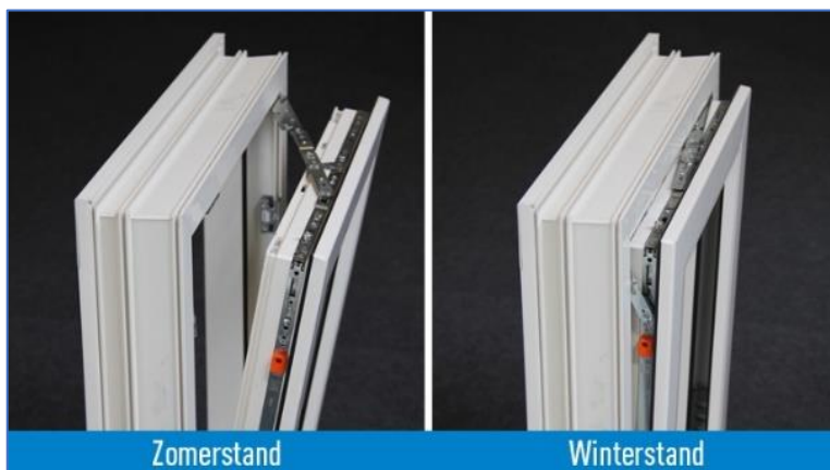
Figuren 9. Links . Bij moeilijk te bereiken (hoge positie) klepramen worden deze niet regelmatig opgezet of op kierstand. In sommige situaties zit er ook nog een raamslot op. Dit kan verbeterd worden door de toepassing van uitzetijzers die vanuit een lagere positie te bedienen zijn. (Euro 175). Rechts . Er zijn draai-kiep ramen in de markt die een zomer en winterstand (kleinere kier) hebben. (Internet Bohaco). Bij een te grote kier kan er ook een extra vang op het kozijn geplaatst worden die een kleine kier geeft.
