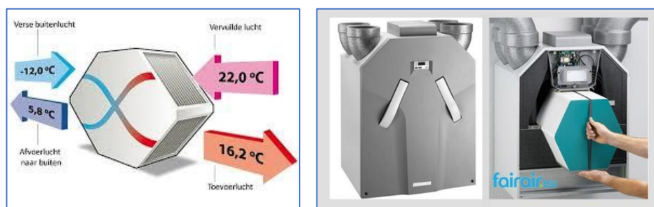
Figuur 65. Schematische voorstelling van een lucht-lucht warmtewisselaar en foto van vervangen van een filter.
