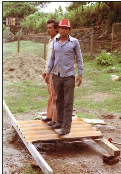
Auteur en producenten op een dakplaat om de sterkte te testen.
