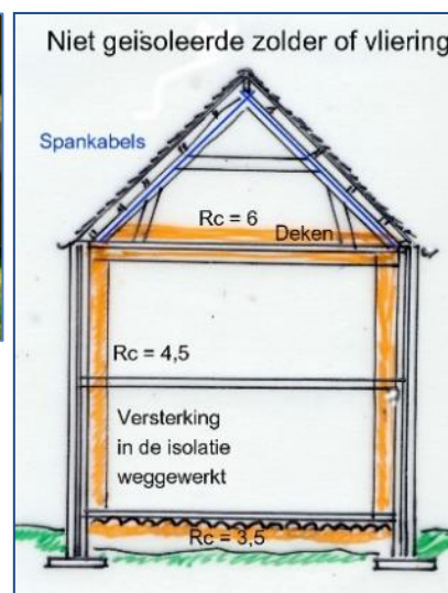
Figuur 9-35. Wanneer de zolder of vliering niet verwarmd hoeft te zijn kan de isolatie op de zoldervloer gelegd. Met een gecacheerde PIR-plaat is de ruimte goed voor opslag te gebruiken. Met samendrukbaar materiaal zoals glaswol of steenwol tussen regels en daaroverheen een multiplex of OSB-topvloer is de vloer voor opslag te gebruiken.
