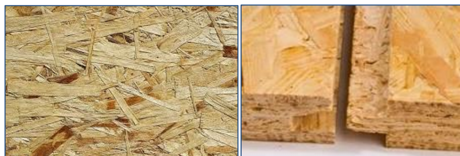
Figuren 8-56. OSB platen, langvezelige spaanplaten met dichte persing. Deze zijn er in verschillende diktes en sterkten.
