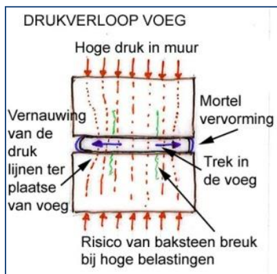
Figuren 8-77. Drukverloop in de voeg van hoog-belaste bakstenen. Hetzelfde geldt voor blokken.
