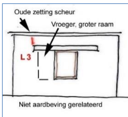
Figuren 7-37. Lange latei met scheur naar dakrand. De oude, lange latei is een muurversterking, maar de kleine afstand tot het dak veroorzaakt hier een scheur aan het einde.
