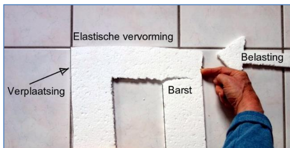
Figuren 7-10. Demonstratie scheurvorming met piepschuim plaat (EPS). Door op het schaalmodel te drukken, treedt er een elastische vervorming op. Als de materiaalsterkte wordt overschreden treedt een barst op. De locatie van de barst hangt af van de penantbreedte, de bovendruk en de sterkte van de zone boven de deur, of de verzakking van de ondervloer (fundering).
