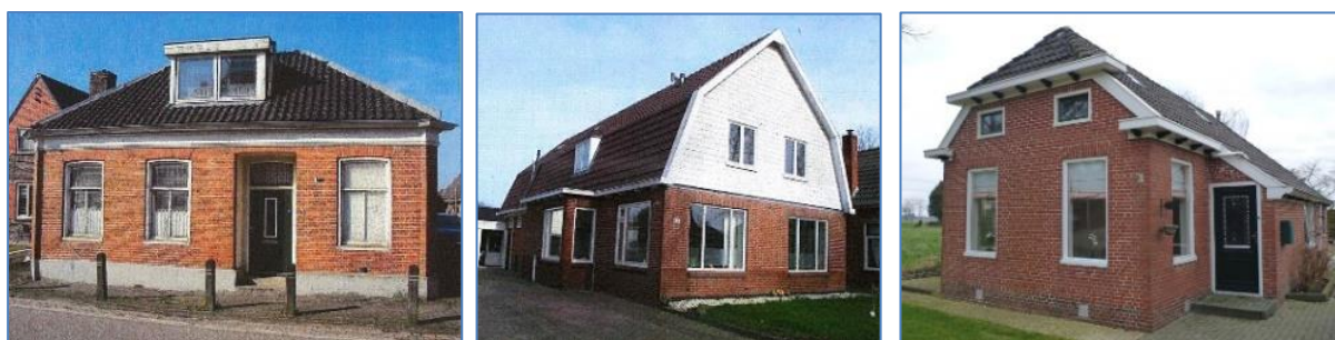
Figuren 7-8. Veel voorkomende typologieën in de provincie Groningen. Per typologie kan een standaard versterkingsmethode en plan voor verduurzaming gemaakt worden, zodat er per individueel gebouw geen eigen en heel tijdrovend en duur rekenprogramma hoeft te worden opgezet. Met inzicht over de algemene seismische problematiek kan een kleine aannemer dan de versterkingen toepassen.
