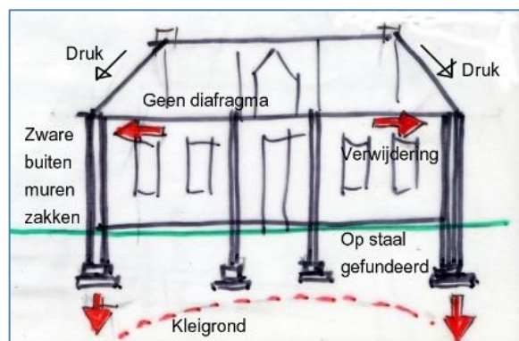
Figuur 7-4. De steeds buitenmuren en binnenmuren kunnen verschillend verzakken. Bij vochtige grond en trillingen kunnen binnen en buitenmuren verschillend verzakken. Afhankelijk van het ontwerp van de kapconstructie kunnen de spanten een zijwaartse druk op de muurplaat uitoefenen.
