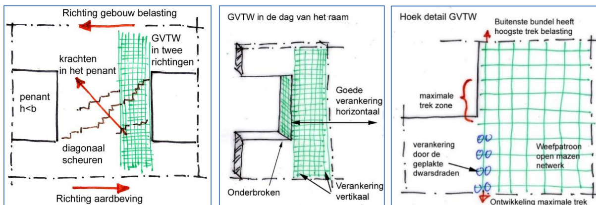
Figuren 6-36. Penanten tussen ramen krijgen het eerste scheuren. Langs de zijkanten van de ramen ontstaat de grootste spanning. Onder en boven de raamopening moet daarom voldoende plaklengte aanwezig zijn om de krachten van het metselwerk over te dragen op het GVTW. Midden. Smalle penanten kunnen met het GVTW rondom worden geplakt wanneer deze penanten aan de buitenzijde worden gepleisterd.
