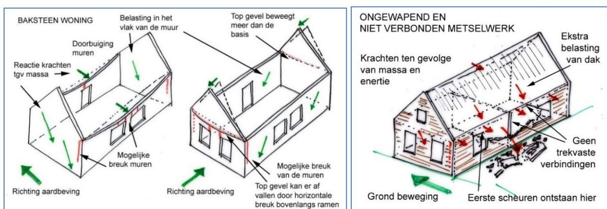
Figuren 6-4. De krachten vanwege de gebouwmassa. Deze moeten via de muren (in het vlak van die muren) naar de fundering worden afgevoerd. Er moet voorkomen worden dat die belastingen loodrecht op de muren komen te staan. Vrijstaande muuronderdelen moeten daarom kort/laag blijven of speciaal versterkt.
