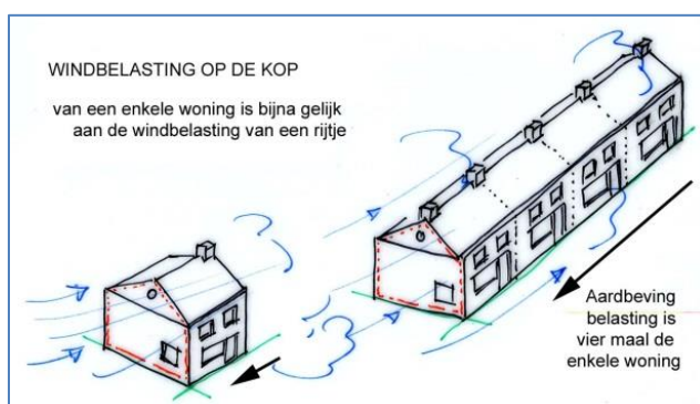
Figuren 6-69. Rijtjeswoningen zijn meestal slechts op windbelasting berekend. Door de uiteinden te versterken kan dit probleem worden opgelost.
