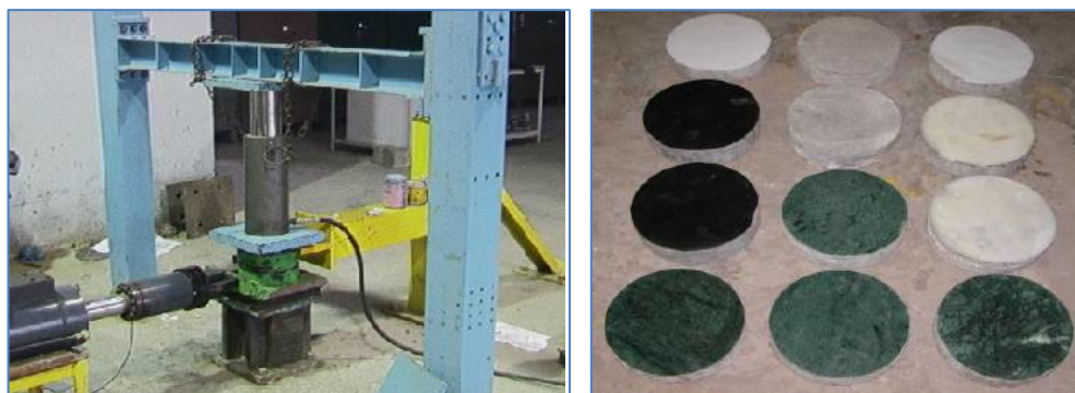
Figuur 5-37. Testen zijn uitgevoerd met gepolijst marmer. Marmer 27 heeft een wrijvingscoëfficiënt van \mu 0,05 tot 0,2 onder een druk van 1,6 to 3,8 \text{N/mm}^2 of Mpa.
