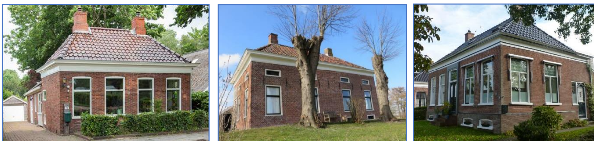
Figuren 5-50: Voorbeelden van in kalkmortel gemetselde kleine woningen.
