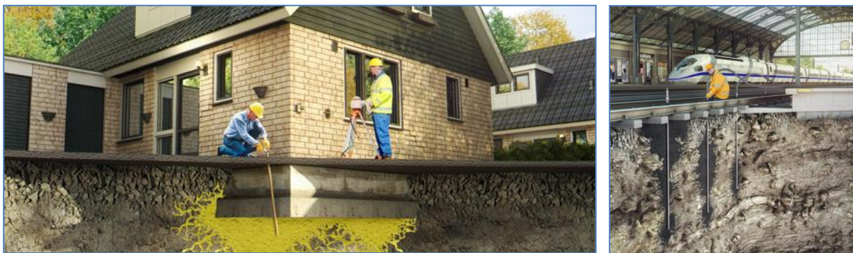
Figuren 4-50. Uretek met injecties van een expansiehars (epoxy).
