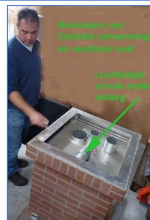
Figuren 3-59. Meekro fabricage van lichtgewicht composiet schoorstenen. In 2020 zijn er verschillende bedrijven in de provincie Groningen die lichtgewicht schoorstenen maken en plaatsen.
