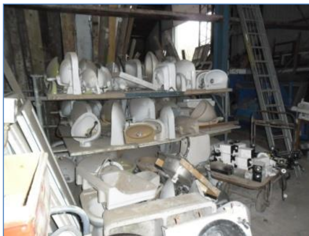
Figuur 12-19. Wastafels hergebruik. Nieuw sanitair is een grote kostenpost. Met nieuwe kranen kan oud sanitair uitstekend dienstdoen. 37
