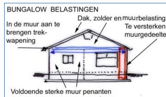
Figuur 23. Zonder de dak belasting, moet de uitgebogen latei boven het grote raam teruggedrukt worden én horizontaal versterkt, én het plafond diafragma moet versterkt worden.
