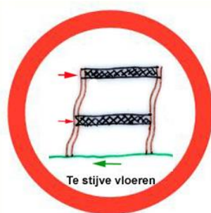
Figuren 1-35. De slechte situatie met stijve vloeren en dunne flexibele kolommen.
