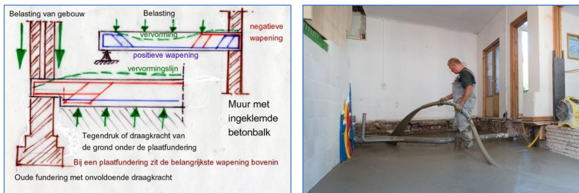
Figuren 1-85. Bij plaatfundering zit de betonwapening bovenin.
